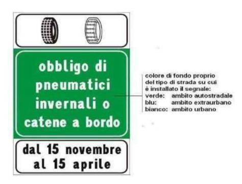
(Per le modalità di installazione e di dimensionamento del segnale, anche in funzione del numero di righe prescelto, si applicano le norme degli articoli 77, 78, 79, 80, 81, 82, 83, 124 e 125 del Regolamento di esecuzione e di attuazione del nuovo Codice della strada (DPR n. 495/1992).)
